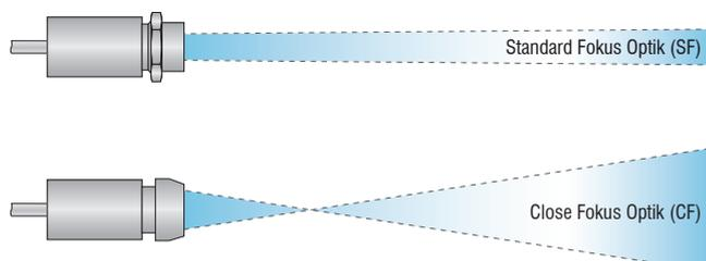
Beeinflusst wird der Fokuspunkt bzw. dessen Größe auch vom Distanzverhältnis, welches die optische Auflösung definiert. Es beschreibt, wie groß der Messfleck bei einer gegebenen Entfernung ist und ist definiert als D:S - das Verhältnis des Messabstandes (Entfernung Sensor zum Messobjekt) zum Messfleckdurchmesser.
