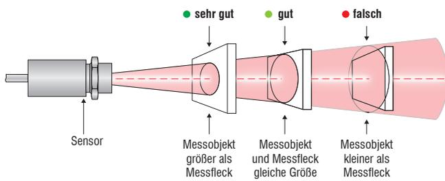
Über entsprechende Wahl des Fokus können die Spot-Größen verändert werden. So kann z.B. eine CF-Linse sehr kleine Spots generieren, während eine SF-Optik größere Spots erzeugt, dafür die Messung über weitere Stecken ermöglicht.
