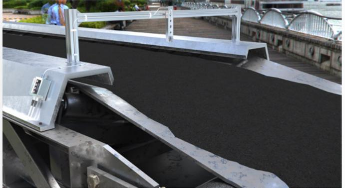
Prüfung der Verarbeitungstemperatur beim Verladen von Asphalt mit thermoMETER UC
