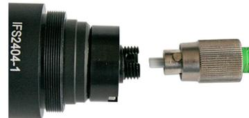
Nut der Buchse am Sensor (links) und Führungsnase eines FC-Sensorsteckers (rechts)
