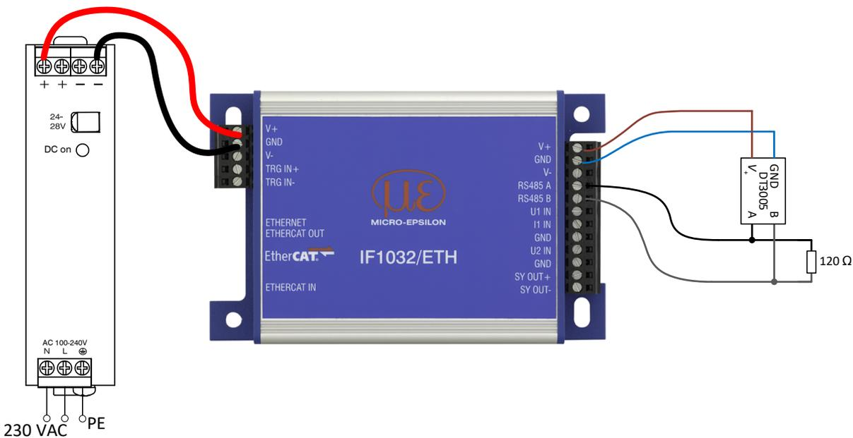
Abb. 21 Anschluss der eddyNCDT 3005 Controller an das Schnittstellenmodul IF1032/ETH mit optionalem Netzteil PS2020
