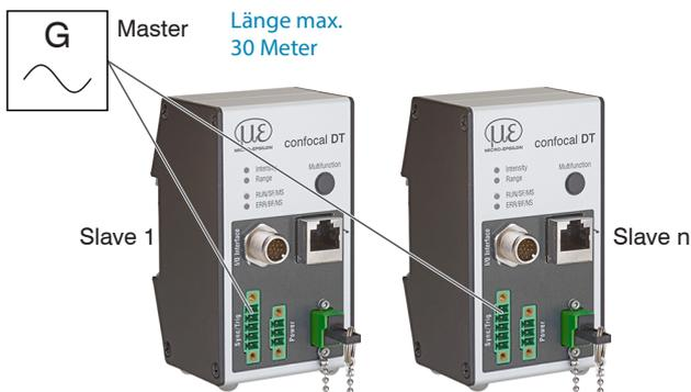
Abb. 29 Synchronisierung mehrerer Controller, sternförmig
