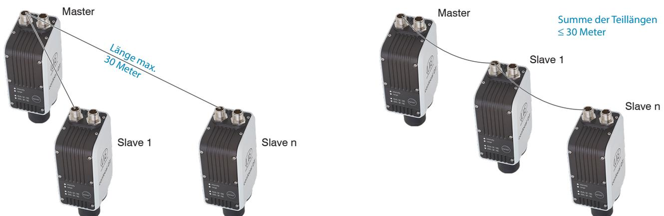
Abb. 14 Synchronisierung mehrerer Sensoren, links sternförmig, rechts verkettet
