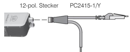
➤ Verbinden Sie das IFD2410/2415 und Netzwerk mit einem geschirmten Ethernetkabel (Cat5E, Patchkabel 2 m aus dem Lieferumfang, Gesamtkabellänge kleiner 30 m).
