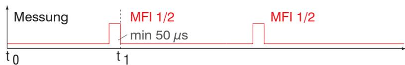
Abb. 63 Ablaufdiagramm für Nullsetzen, Mastern (Taste Multifunction)
